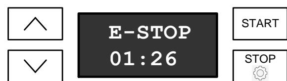
Wenn die **STOP-Taste** bei geöffneter Abdeckung gedrückt wird, wird der Cremigrühr-Zyklus ausgeschaltet (das Honigrührwerk startet nach dem Schließen der Abdeckung nicht wieder). Die Rührvorgangszeit wird auf Null zurückgesetzt.
