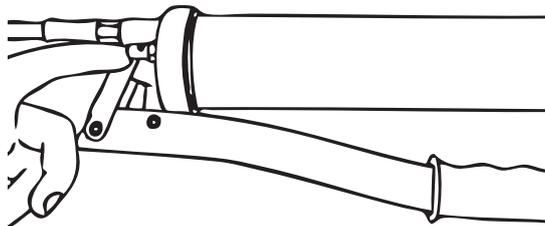
Entlüften des Fettbereichs über den kombinierten Füll-/ Entlüftungsrippel am Fettpressenkopf, durch Lösen von Pressenkopf- und Rohr (max. ½ Umdrehungen) oder durch mehrmaliges Betätigen des Handhebels.
