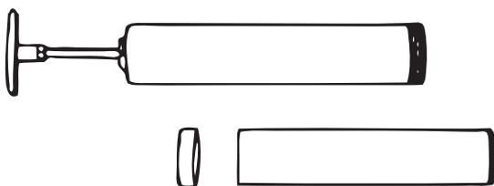
Verschlusskappe von der vollen Fettkartusche entfernen und diese in das Fettpressenrohr einführen.
