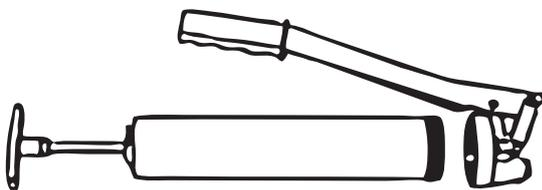
Schubstange nach hinten ziehen und den Fettpressenkopf abschrauben.
