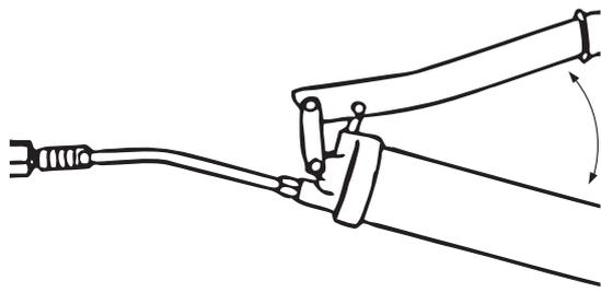
Durch Betätigen des Handhebels den Abschmiervorgang ausführen.
