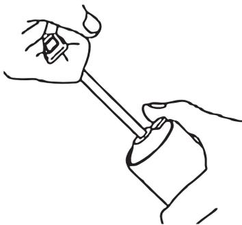
Unter Zug der Schubstange, die Sperrklinke betätigen, und die Schubstange wieder in das Rohr schieben.
