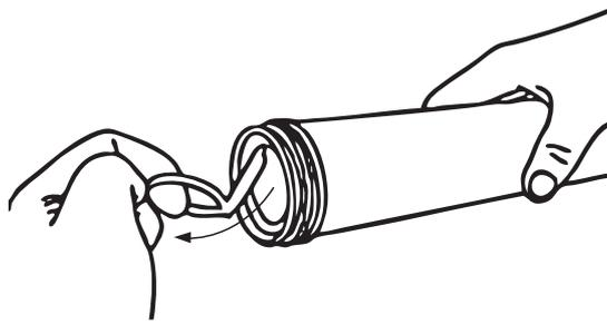
Erst dann den „Pull-off“-Verschluss der Kartusche abreißen und den Fettpressenkopf aufschrauben.
