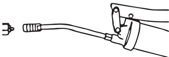
Fettpresse mit dem Hydraulik-Mundstück auf den Schmiernippel aufsetzen.
