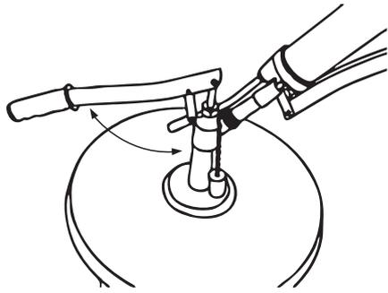
Durch Betätigen des Füllgerätes die Fettpresse befüllen.
