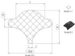
**5 Füllprofil zum Dichtprofil**
