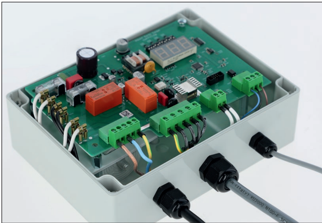
Figure 9 : Carte dans le boîtier de contrôle (condensateur derrière la carte)
