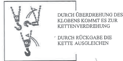
Abb. 2 Überdrehung der Kette
