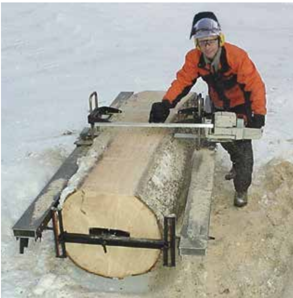
Big Mill PRO: LSG mit Doppel Führungsholmen, EXT Arm und Befestigungsplatten EXT. Die Gleitprofile (Nr.4 Seite 27) dürfen den Baumstamm nicht berühren.
